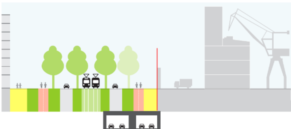
Figuur 2-22 Voorbeeld profiel kruising Binckhorstlaan Maanweg
