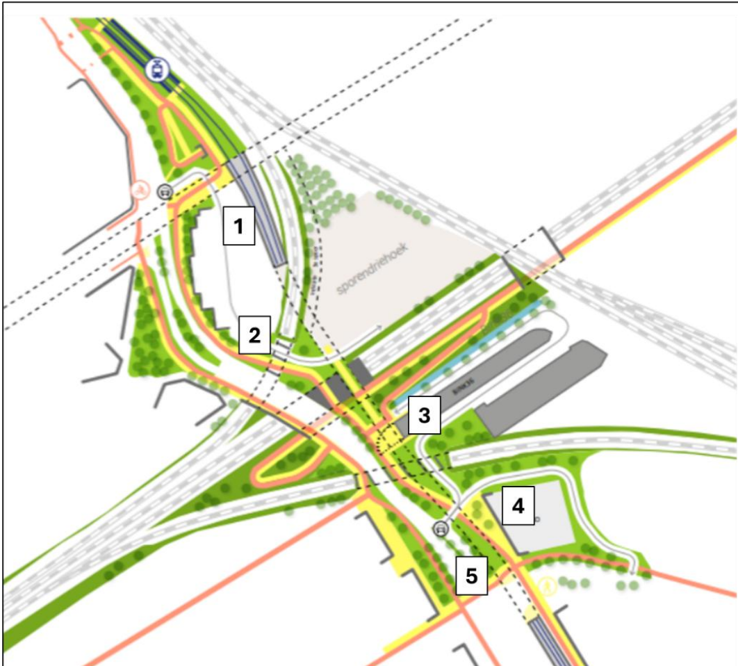
Figuur 2-32 Het tracé en de inrichting van de openbare ruimte voor de tunnelvariant. Bron: Ontwerpnota Vlietlijn Tunnelvariant Schetsontwerp, concept/0.1, gedateerd 18 april 2025
